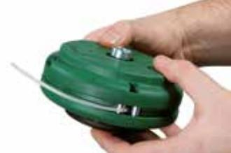
**Закройте крышку головки,**
