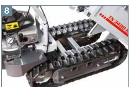
6 Прочное шасси с натяжителем гусениц, идеально сбалансированное для обеспечения правильного распределения груза в кузове и хорошего сцепления с любым грунтом.
