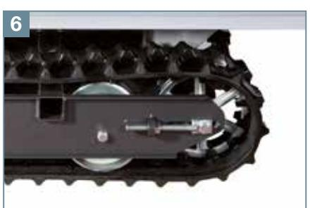
4 Широкие гусеницы обеспечивают хорошее сцепление с любыми типами грунтов (безопасность для оператора).
