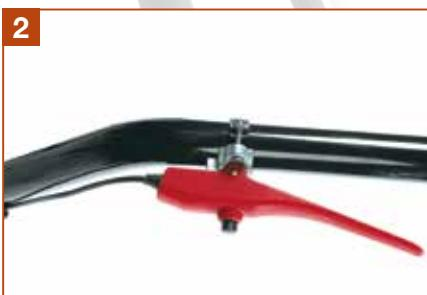
1 В моделях, рассчитанных на 1 оператора, эргономичная ручка обеспечивает удобство работы; кроме того она оснащены предохранительным рычагом, предотвращающим срабатывания по случайному нажатию акселератора.
