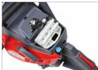
Filtro in nylon per **MT 3710** e **MT 4110**: grazie ad una elevata superficie filtrante aumenta le ore di autonomia di lavoro tra una pulizia del filtro e la successiva.
