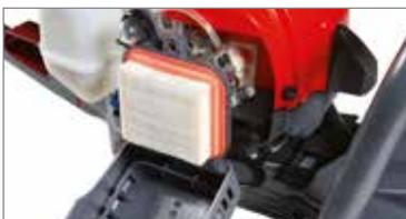
Ampio filtro aria in carta per una maggiore capacità filtrante e una più completa protezione del motore, anche in ambienti polverosi.
