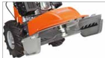
Piatti di taglio in acciaio rinforzato, dotati di ampia zona di scarico del materiale sfalciato.
