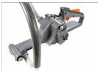
Sistema antivibrante formato da 6 ammortizzatori, 2 a molla e 4 in gomma: interposti tra l'impugnatura comandi ed il basamento assicurano un ottimo isolamento dell'operatore dalle vibrazioni per un maggiore confort di utilizzo.
