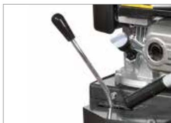
Comando selettore delle velocità con leva.
