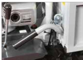
Ribaltamento manuale con sistema di bloccaggio automatico.
