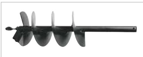
Punte a 1 principio disponibili sia con tagliente singolo che doppio (quest'ultimo consente una migliore efficacia di penetrazione nel terreno e agevola l'uscita della terra smossa). Dotate di puntale e tagliente in acciaio speciale per offrire massime prestazioni e resistenza all'usura. Compatibili
