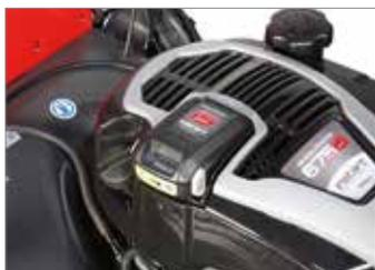
Il modello **TBXE** con motore Briggs & Stratton è dotato di avviamento elettrico a batteria ricaricabile che assicura una partenza senza fatica.
