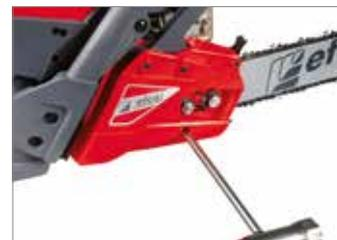
Tendicatena in posizione laterale per **MT 3710** e **MT 4110**: rende più agevole la fase di registrazione della catena evitando ogni rischio di contatto con la catena. I dadi di bloccaggio, solidali al carter copricatena, facilitano l'operazione di serraggio in quanto non possono cadere e/o perdersi.
