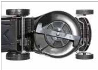
Scocca in alluminio pressofuso con spessore 4 mm: assicura peso contenuto ed elevata resistenza meccanica all'usura e alla corrosione.
