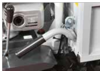
Ribaltamento manuale con sistema di bloccaggio automatico.
