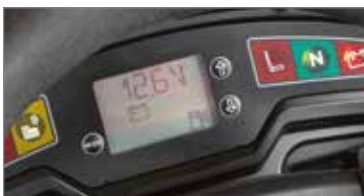
Il display LCD permette una rapida ed immediata visualizzazione delle principali informazioni del trattorino come, ad esempio, ore d'esercizio, tensione batteria, livello serbatoio.
