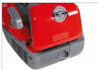
Gancio per moschettone: ripiegabile ed in acciaio è pensato per un aggancio rapido della macchina all'operatore.
