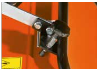
Molla di regolazione della profondità lavoro. Garantisce sempre il mantenimento della posizione prestabilita.
