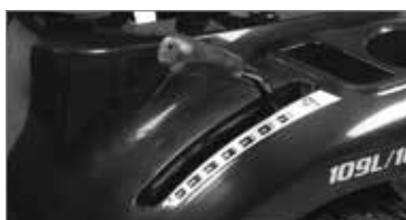
Regolazione altezza di taglio tramite pratica leva posta a portata di mano con scala graduata che consente un'immediata visualizzazione del livello di altezza di taglio desiderato.
