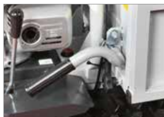
Ribaltamento manuale con sistema di bloccaggio automatico.
