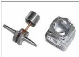
Pistone a 2 segmenti elastici, cilindro pressofuso con riporto al nichel, biella e albero motore forgiato: garantiscono al motore grande resistenza e durata nel tempo.
