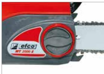
Regolazione della tensione della catena mediante semplice manopola, senza l'ausilio di utensili.
