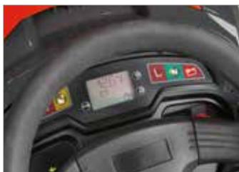
Display elettronico LCD che permette una rapida ed immediata visualizzazione delle principali informazioni del trattorino come, ad esempio, ore d'esercizio, tensione batteria, livello serbatoio carburante.
