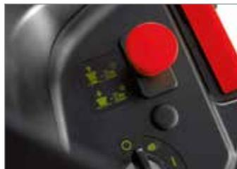
L'innesto della frizione elettromagnetica avviene rapidamente e in modo silenzioso tramite un comodo pulsante posto sulla plancia dei comandi.
