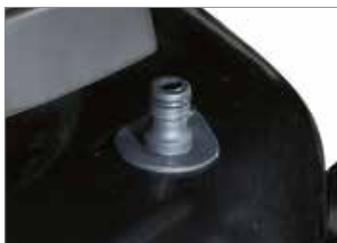
Il connettore rapido, "Deck Wash System", posto direttamente sul piatto di taglio, permette di indirizzare l'acqua direttamente all'interno, facilitando quindi le operazioni di pulizia dell'apparato di taglio.
