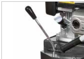
Comando selettore delle velocità con leva.
